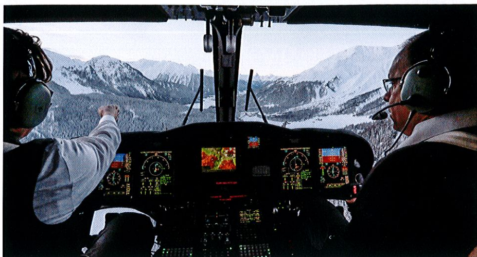
Anflug auf den Heliport in Davos. Der AW139 ist mit Avionik auf Airliner-Standard ausgerüstet.
